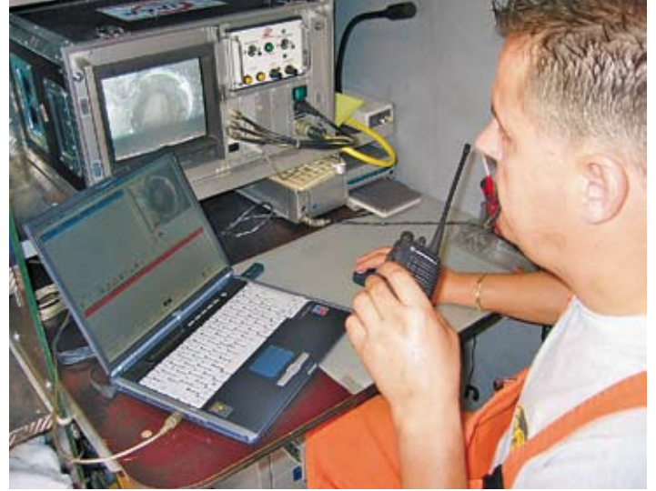
Mittels Kleinst-TV-Kamera rasch lokalisiert: Kalk verengt das Rohr.
