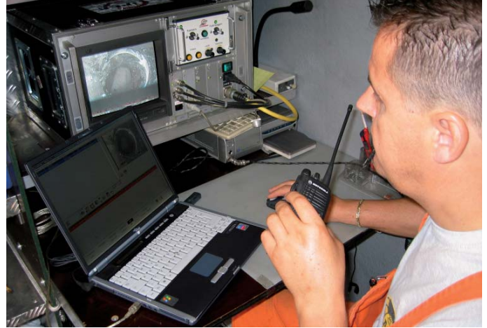
Genauere Schadenserkenntung und Aufzeichnung auf Video im Kommando- und Einsatzfahrzeug.
