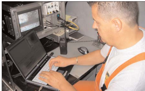
Kanalfernsehen: Protokolliert und analysiert die Situation.
